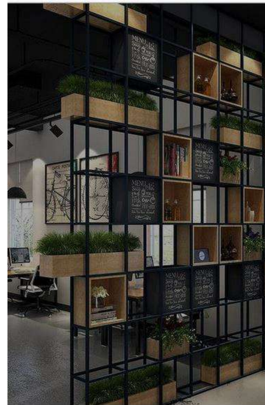
Libreria realizzata con tubolare di ferro verniciato da 50 x 50 mm, fioriere e vani a giorno realizzati con abete di recupero. Alcuni inserti saranno realizzati in lavagna di recupero.
